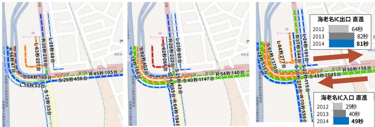
図10 右左折方向別の交差点通過時間（平日7-19時）
